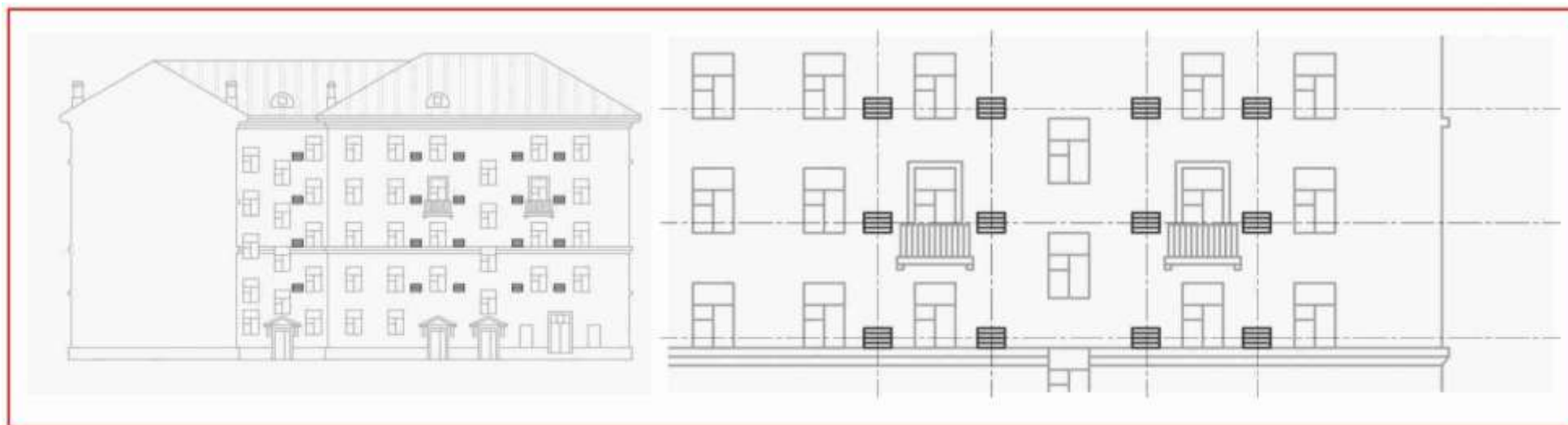
Пример правильного размещения кондиционеров на внутривором фасаде
