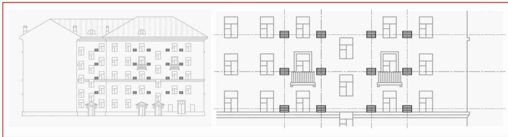
Пример правильного размещения кондиционеров на внутривором фасаде
